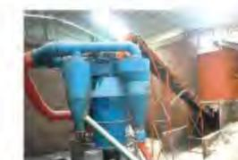
KX型高细转子式选粉机是我公司经多年研究开发的外部循环式带转子的改进型选粉机。它是在转子式选粉机的基础上，将平面涡流理论运用于旋流式选粉机设计而成。经实践使用证明，选粉效率达85%以上，细度调节灵活方便，性能可靠。
