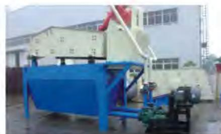
细砂回收装置是我公司吸收国外的先进技术，结合我国的实际情况而精心设计的。广泛应用于水利水电、玻璃厂、建材砂石料细粒、选煤厂粗煤泥的回收及环保工程（泥浆净化等）。
